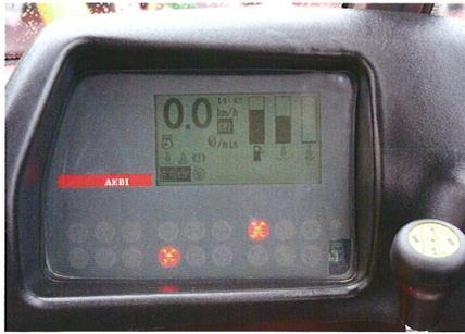
Der Bildschirm dient als Armaturenbrett und wird gleichzeitig für Einstellungen benutzt. Der Kontrast passt sich automatisch dem Umgebungslicht an.
