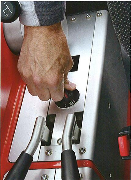
Die automatische Feststellbremse lässt sich sicher und einfach bedienen. Die Federspeicherbremse wirkt direkt auf die Hinterachse.
