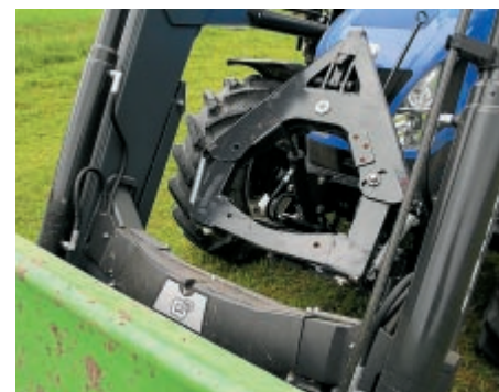
Wegen des Hubwerks sind längere Frontladerschwingen nötig.
