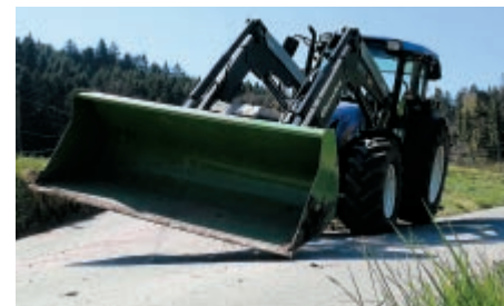
Die Bodenanspassung ist mit der Hinterachsführung nicht optimal.
