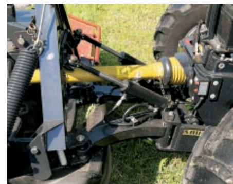
Das Polytrac-Hubwerk hat eine integrierte Seitenverschiebung.
