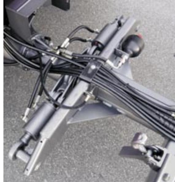
**Ein wichtiges Sicherheits-element: die hydraulische Verdrehdämpfung ohne abrupten Anschlag. Bei einem maximalen Verdrehwinkel von fast 24° je Seite bleiben die Räder immer am Boden.**
