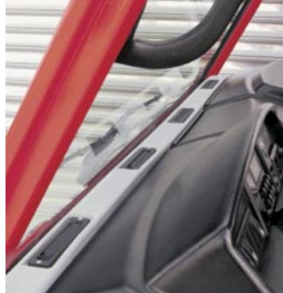
**Die Ausblasöffnungen für die Frontscheiben der auf Wunsch erhältlichen Defroster- und Heizungsanlage. Nicht sichtbar: die Ausblasöffnungen zum Fussraum hin.**
