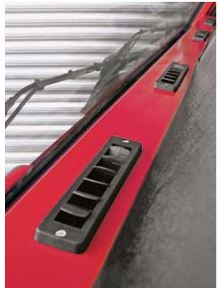
**Die Ausblasöffnungen für die Frontscheiben der auf Wunsch erhältlichen Klimaanlage bzw. der sehr leistungsfähigen Defroster- und Heizungsanlage. Nicht sichtbar: die Ausblasöffnungen zum Fussraum hin.**
