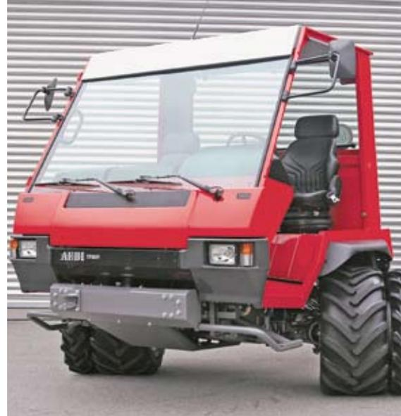
**Auf Wunsch: gefederte Kabine. Kabinenaufhängung mit Luftfedern und hydraulischer Dämpfung für optimalen Fahrkomfort. Und zwar unabhängig von der Zuladung. Auch am Steilhang, denn die Stabilisatoren sorgen automatisch dafür, dass die Kabine sich nicht hangabwärts neigen kann.**
