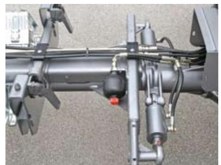
Ein wichtiges Sicherheitselement: die hydraulische Verdrehdämpfung ohne abrupten Anschlag. Bei einem maximalen Verdrehwinkel von fast 24° je Seite bleiben die Räder immer am Boden.
