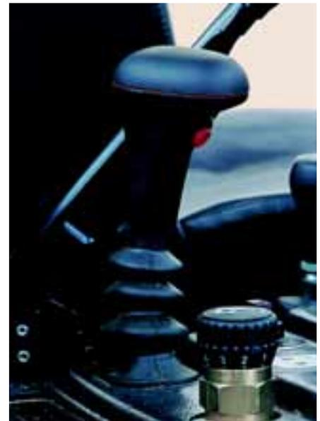
Kein langes Hantieren mit Hebeln, sondern nur noch roten Knopf drücken (auskuppeln), den Hebel bewegen (Zapfwelle einschalten) und den Knopf loslassen (einkuppeln). Diese elektrohydraulische Zapfwellenkupplung ist wirklich patent und erleichtert Ihnen die Arbeit.
