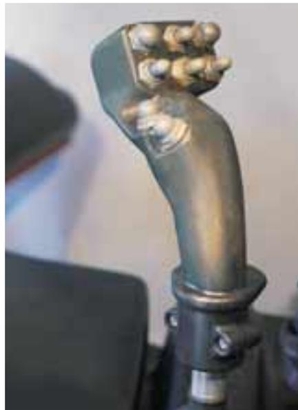
Alles im Griff: heben, senken, schwenken, kippen, vorwärts, rückwärts. Mit dem multifunktionalen Tastengriff werden sämtliche hydraulischen Funktionen elektrohydraulisch gesteuert. Z.B. Ladegeräte, Kipper, Mist- und Kompoststreuer, Saug- und Druckfass oder Schneepflug.
