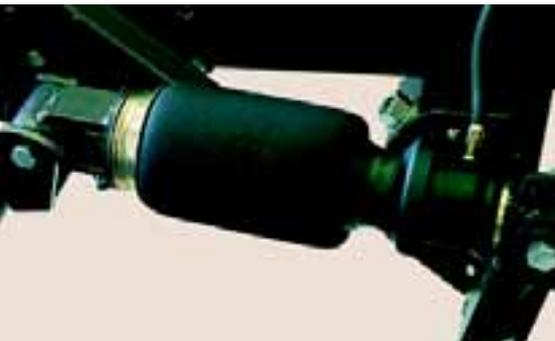
Die Luftfederungs-Elemente mit hydraulischer Dämpfung garantieren optimalen Fahrkomfort. Und zwar unabhängig von der Zuladung. Auch am Steilhang, denn die Stabilisatoren sorgen automatisch dafür, dass die Kabine sich nicht hangabwärts neigen kann.
