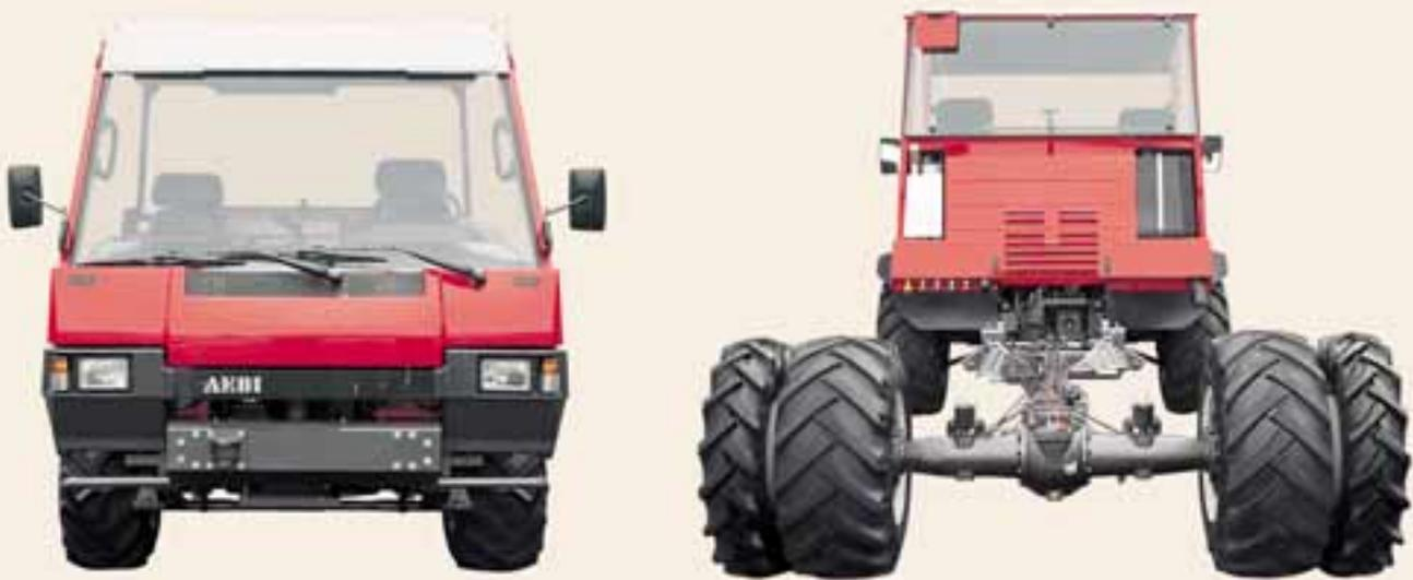
**Aebi hat ein klares Konzept, ein durchdachtes System. Von A bis Z. Das entdecken Sie an vielen, zum Teil einzigartigen Vorteilen und Eigenheiten. Typisch Aebi sind die leistungsstarken Turbo-Motoren mit rasantem Drehmomentanstieg. Die Versionen für 30 km/h oder 40 km/h. Das leicht schaltbare Halbgang-Reversiergetriebe. 2 mal 16 Gänge. Permanenter Allradantrieb. Scheibenbremsen. Hydraulische Bremskraftverstärkung. Tiefer Schwerpunkt und grosser Lenkeinschlag. Hohe Nutzlast. Und, und, und.**
