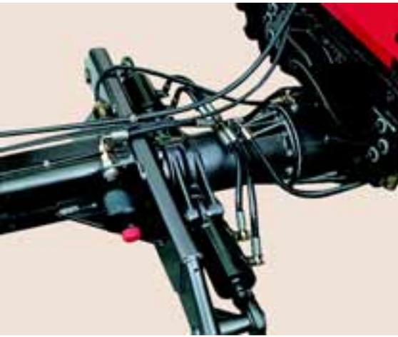
**Progressiv wirkende hydraulische Verdrehdämpfung zwischen Vorder- und Hinterachse.**
