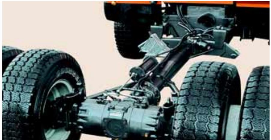
**Hightech und Sicherheit. Bei Aebi ist der permanente Allradantrieb mit elektrohydraulischer Sperrung der Achsdifferenziale und des Längsdifferenzials ausgerüstet. Und bei Aebi laufen die Scheibenbremsen im Ölbad.**
