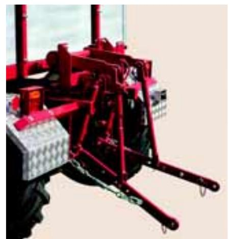
**Für zusätzliche Anbaumöglichkeiten: Heck-Dreipunktkraftheber nach Kat. I+II.**
