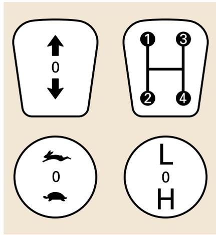
**Leicht schaltbares und lastschaltbares Halbgang-Reversiergetriebe mit total 16 Vorwärtsgängen und 16 Rückwärtsgängen.**
