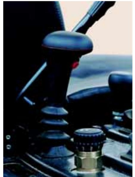
Kein langes Hantieren mit Hebeln. Die elektrohydraulisch betätigte Zapfwellenkupplung ist wirklich patent.
