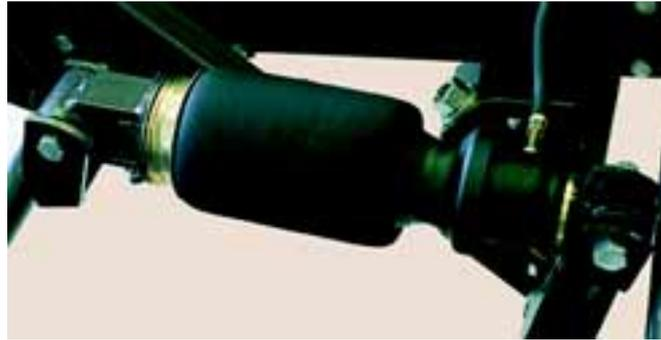
Die Luftfederungselemente mit hydraulischer Dämpfung garantieren optimalen Fahrkomfort, und zwar unabhängig von Zuladung, Aufbauten oder Frontgeräten.
