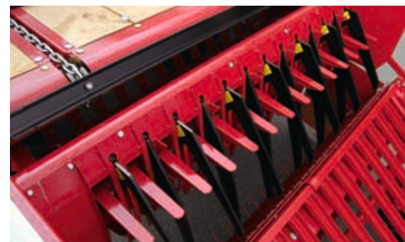
Der breite und weite Förderkanal mit den drei Fördertraversen und den maximal 13 Messern auf zwei Schnittebenen.
