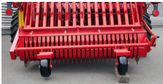
Die perfekte Bodenanpassung mit der Kontur -Steuerung – bestehend aus der automatischen Höhenanpassung und über die Tastrollen gesteuerten Pick-up-Zinken – und dem Pendel-Pick-up.
