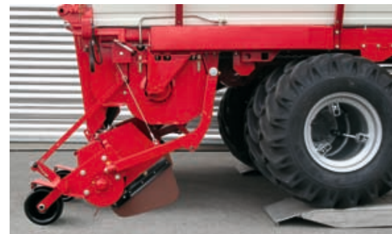
Pick-up in maximaler Tiefstellung. Einstellschiene für die Kontur -Steuerung und die Hochstellung der Tastrollen für das Standladen, um ungehindert und bequem zu laden.
