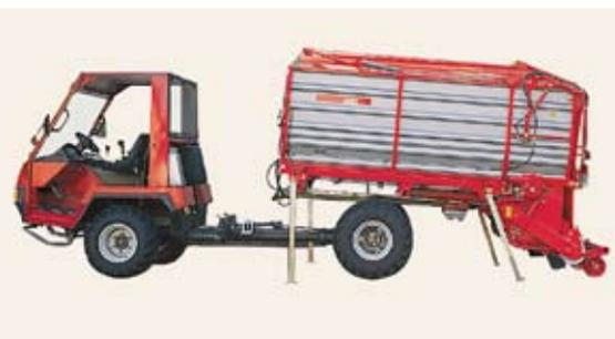
**Version für kurzen oder langen Radstand. Hier beim Geräteschnellwechsel.**
