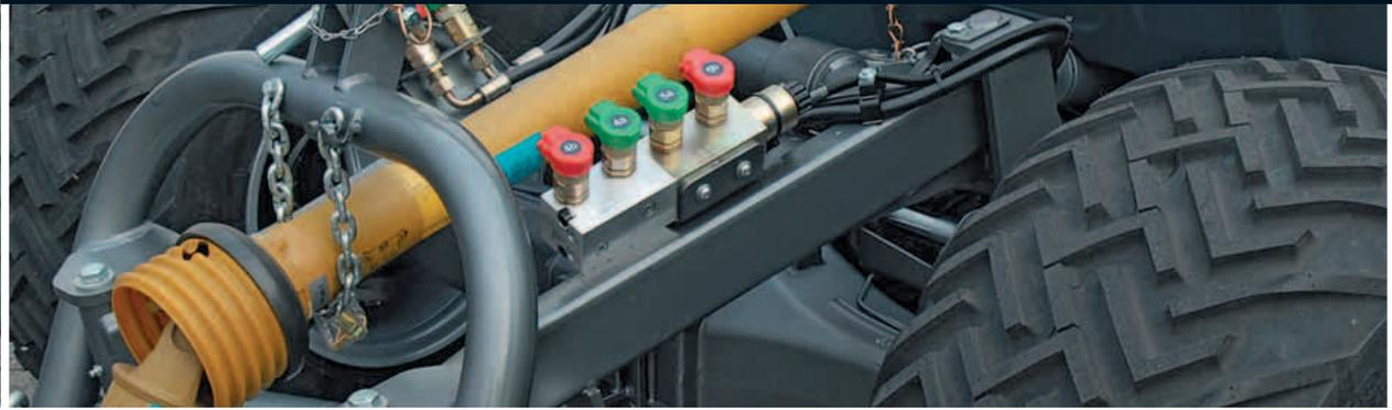
Hydraulikanschlüsse am Fronthubwerk
