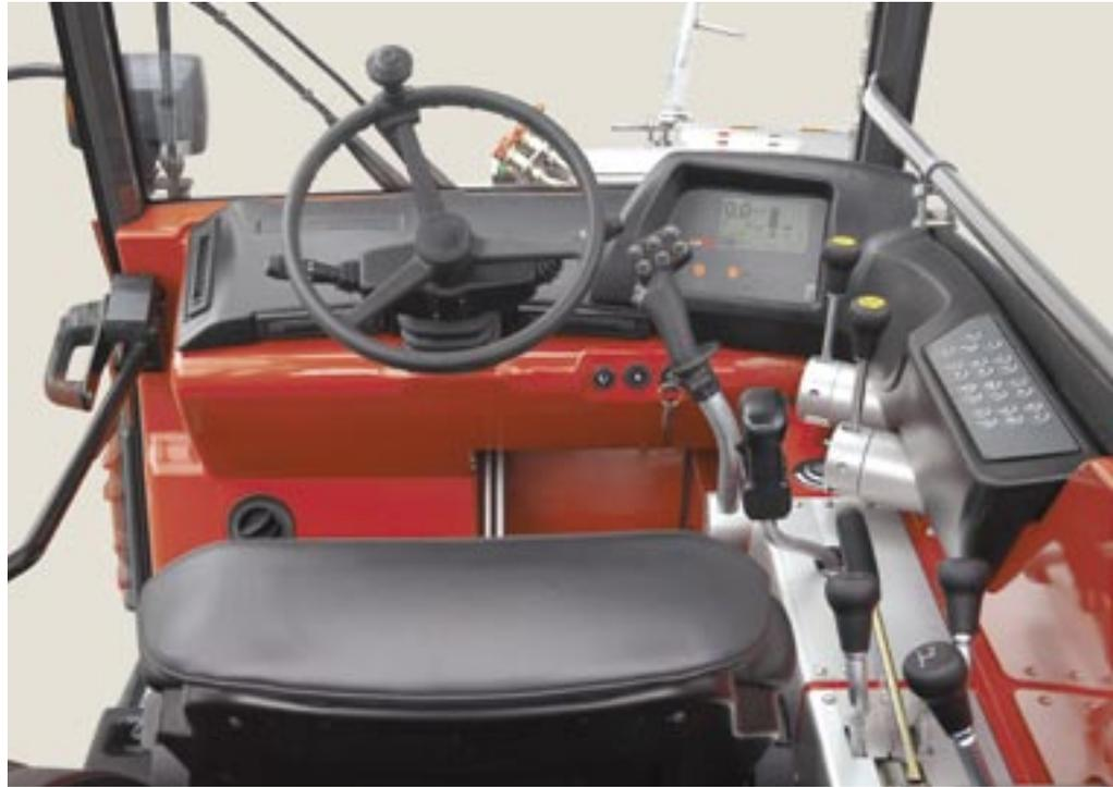
**Dank übersichtlicher Anordnung aller Bedienelemente hat der Fahrer den TT170 immer voll im Griff. Die zentrale Elektronik zeigt auf einem grossen Bildschirm und via Kontrollleuchten den aktuellen Betriebszustand an.**
