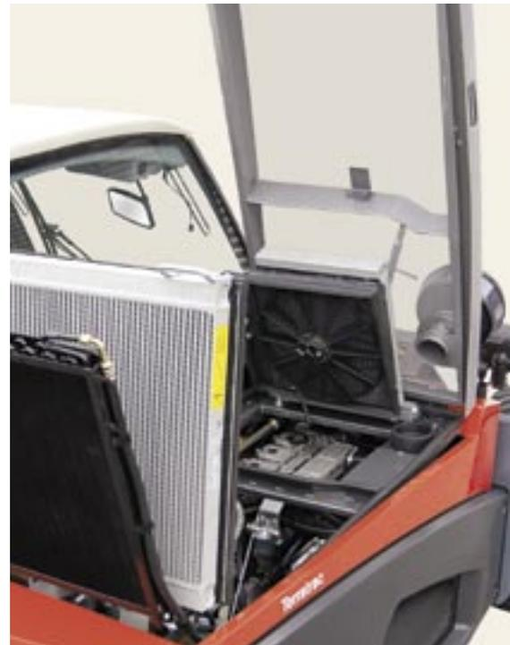
Das Kühlsystem des Dieselmotors und des Hydrauliköls ist speziell auf staubige Verhältnisse abgestimmt. Zum Reinigen einfach aufklappen.
