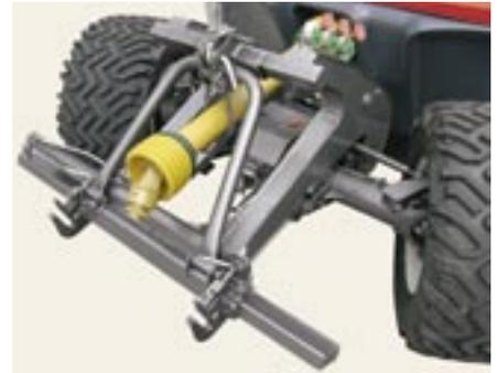
**Die moderne Elektronik des TT170 misst den Hydraulikdruck beim Anheben des Anbaugerätes automatisch. Der Fahrer kann dann den gewünschten Entlastungsgrad in Prozenten eingeben, und das Hydrauliksystem stellt den nötigen Entlastungsdruck selbst ein. Dank dem kann sich der Fahrer ausschliesslich auf die eigentliche Arbeit konzentrieren.**
