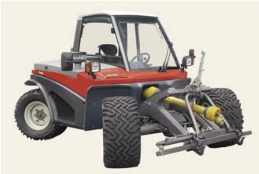
**Der Hangergeräteträger und Spezialtraktor Terratrak Aebi TT170 ist ganz neu. Er wurde auf der Grundlage der bewährten Aebi-Terratrak-Konzeption neu entwickelt.**
