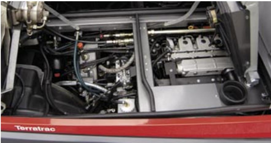
Der VM-Dieselmotor mit 50 kW (68 PS) von Detroit Diesel ist dank der direkten Einspritzung enorm durchzugsstark und sparsam. Durch Aufklappen der Kühlsysteme ist er rasch zugänglich und einfach zu warten.
