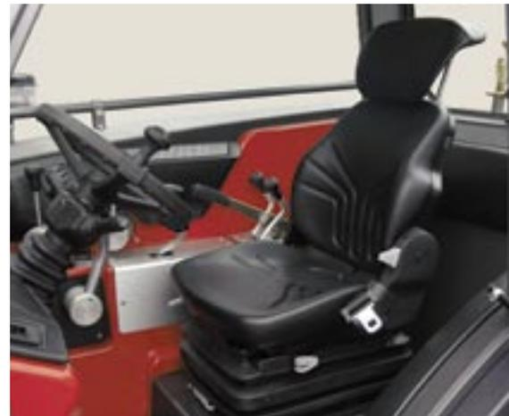
**Der gefederte Fahrersitz ist mehrfach verstellbar und (auf Wunsch) am Hang seitlich schwenkbar.**
