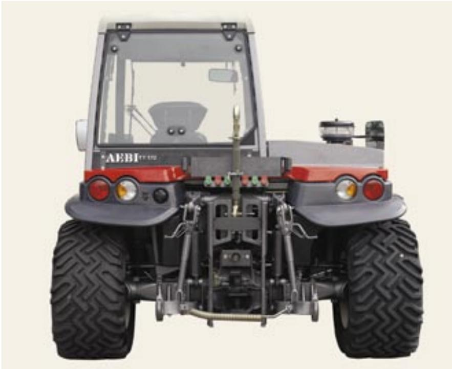
Die Achsen des neuen TT170 sind für überdurchschnittlich hohe Belastungen ausgelegt und der Lenkzylinder ist speziell geschützt angebracht. Typisch für einen Terratrac: die niedrige Bauweise und der tiefe Schwerpunkt.
