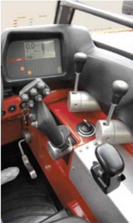
**Am multifunktionalen Griff und Wendeschalthebel bedient man ohne Handwechsel bis zu 21 Funktionen; zum Teil «blind».**
