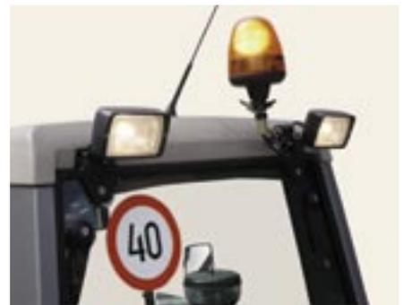
**Auf Wunsch erhältlich: Rundum-Kennleuchte und nach hinten gerichtete, am Dach montierte Arbeitsscheinwerfer.**
