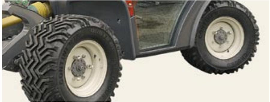
**Reine Hecklenkung für präzises Arbeiten mit dem Frontgerät.**
