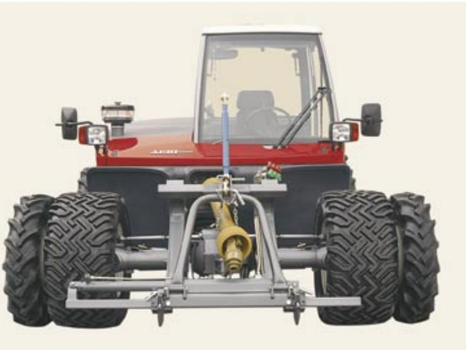
**Die Elektronik des TT270 ermittelt den nötigen Hydraulikdruck zum Anheben der Anbaugeräte automatisch. Der Fahrer kann den gewünschten Entlastungsgrad in Prozenten eingeben, und das Hydrauliksystem regelt den nötigen Druck. Dank dieser Vereinfachung kann sich der Fahrer vermehrt auf die eigentliche Arbeit konzentrieren.**
