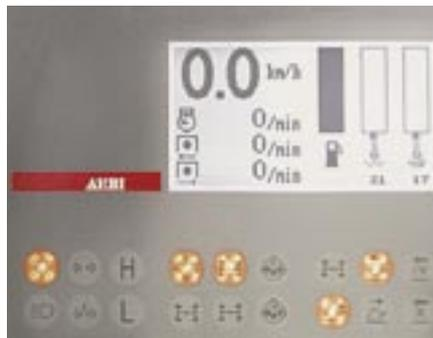
**Auf der Tastatur rechts neben dem Fahrhebel bedient man das Elektronikmenü, welches auf dem Bildschirm (in einer von vier möglichen Sprachen) sichtbar ist. Kritische Werte bezüglich Betriebszustand werden dort sofort markant signalisiert.**
