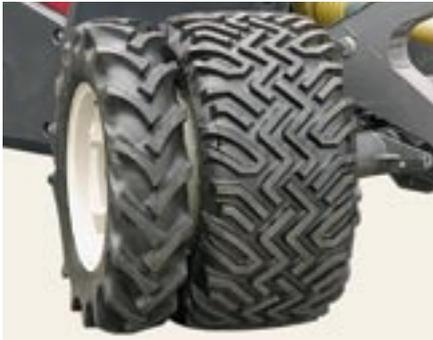
**Um die Sicherheit und den wirtschaftlichen Nutzen in steilen Hanglagen zu verbessern, wird der TT270 mit den neuen «All Ground»-Radialreifen ausgerüstet. Sie können vorne und hinten mit Doppelreifen ergänzt werden. Mit 40 Grad Lenkeinschlag vorne und hinten (30 Grad mit Doppelrädern) ist dieser Terratrac in jeder Lage extrem wendig.**
