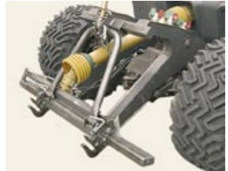
**Vorne und hinten sind je zwei Zapfwellendrehzahlen verfügbar. Die Kupplung erfolgt elektrohydraulisch und ist lastschaltbar. Die Hubwerke sind auch von aussen bedienbar.**
