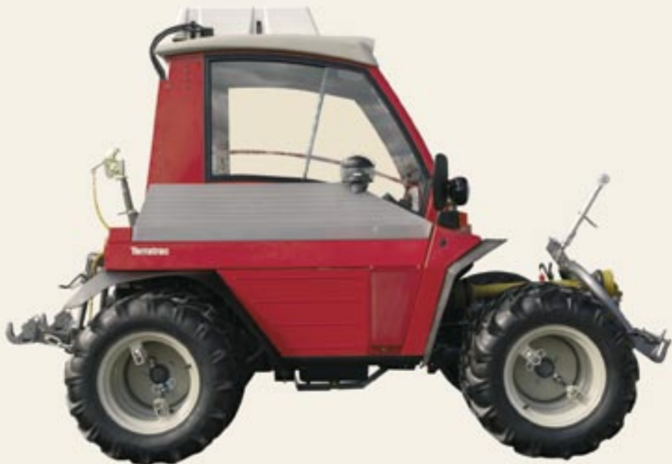
Dank leichtem Gewicht, tiefem Schwerpunkt und fast quadratischer Aufstandsfläche ist dieser Terratrak besonders für den Einsatz in extremen Hanglagen geeignet.
