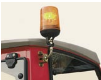
Unentbehrlich für Profis: die abklappbare Rundum-Kennleuchte.
