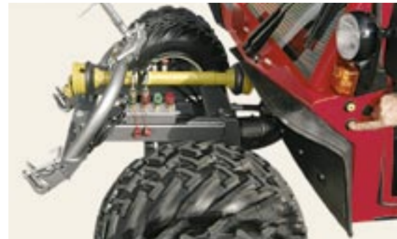
Das Dreipunkt-Fronthubwerk für den universellen Geräteanbau mit der praktischen und zeit-sparenden Aussenbedienung.
