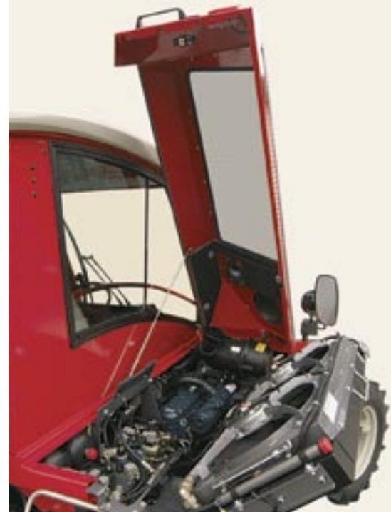
Eine der wartungsfreundlichen Seiten dieser 61 PS leistenden Turbomaschine.
