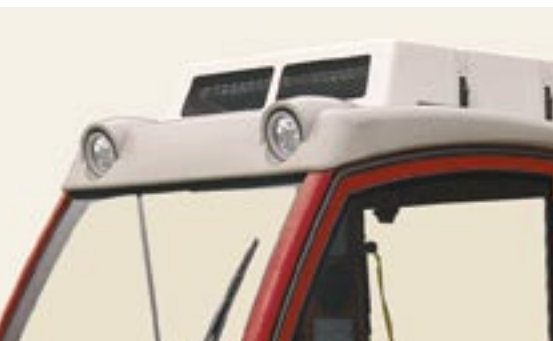
Im Kunststoffdach integrierte Arbeitsscheinwerfer.
