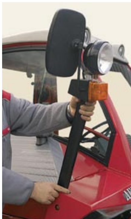
Die Scheinwerfer sind in der Höhe verstellbar oder können bei Bedarf entfernt werden.
