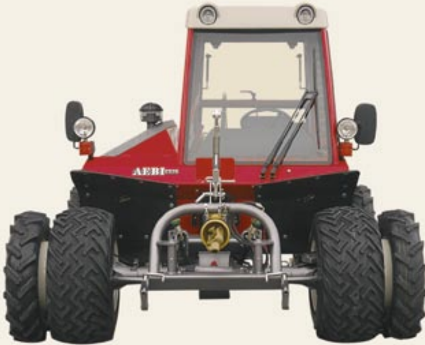
Der wendige TT75 ist enorm bodenschonend. Grossvolumige Niederdruckreifen mit grosser Aufstandsfläche verursachen einen äusserst geringen Bodendruck.
