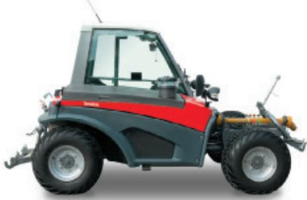
Der Terratrak ist ein Multitalent und kann wirklich enorm vielseitig eingesetzt werden. Für Anwendungen rund ums Jahr lässt sich an Front- und Heckhubwerk eine Vielzahl von Geräten anbauen und über separate Zapfwellen antreiben. So lassen sich im vorderen Arbeitsbereich zum Beispiel Scheiben-, Trommel- oder Schlägelmäher, aber auch Schlauchhaspel, Ladekran oder Kippschaufel anschliessen.
