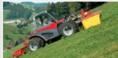
*Terratrak mit Trommelmäher und Aufbereiter*
