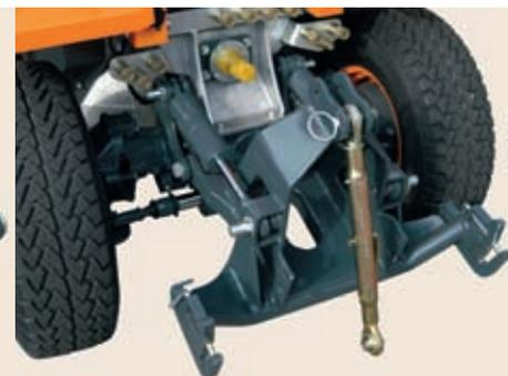
**Vorne und hinten Dreipunkt hydraulik nach Kat. I und hydraulische Geräteentlastung sowie das Aebi-Schnellwechselsystem für die Geräte. Die lastschaltbare Zapfwelle funktioniert beidseitig mit verschiedenen Geschwindigkeiten.**
