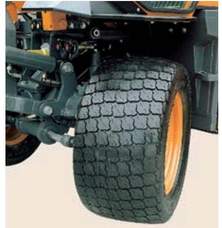
**Doppelstufiges Portalachsgetriebe vorn und hinten. Daher die grosse Bodenfreiheit von 28 cm.**
