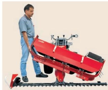
So einfach geht das: Den Mahdenformer zum Balken legen, in die Scharniere einschieben, auf den Aufleger absenken und die Keilriemen auflegen – und schon ist der Mahdenformer einsatzbereit.
