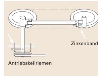
**Spannvorrichtung der Keilriemenantriebe.**
