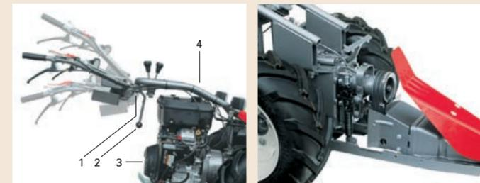
Solche Vorteile weiss man zu schätzen: Lenkerhöhe nach Mass verstellbar (2), gummielagerte Sterze (1), automatische Start-erleichterung des Motors (3) und Transportsperre (4).
