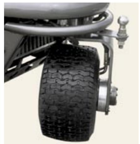
**Jedes Rad ist angetrieben. Auch das dritte. Anderes mehr ist durchdacht bis ins Detail. Siehe die Ziehvorrichtung für leichte Anhänger.**
