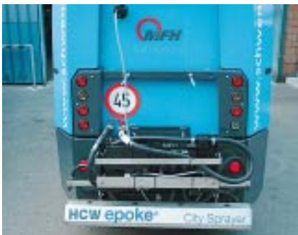
Glatteis bekämpfen mit Salzlösung in wegabhängiger Dosierung. Arbeitsbreite bis 300 cm, Tankinhalt bis 2200 l.
