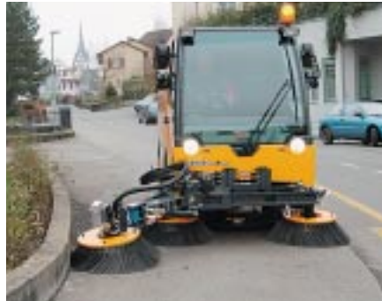
Maximale Kkehrbreite mit Frontbesen: bis 260 cm.
