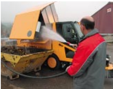
Entleeren in Mulden bis 135 cm Höhe und Ausspritzen mit eigener Wasserpumpe bis 200 bar.
