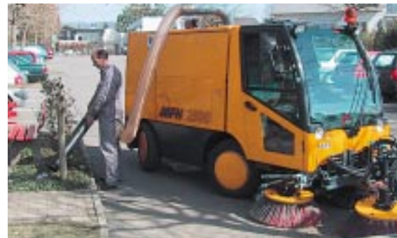
Mit Saugschlauch Rabatten reinigen und Schächte und Abfalleimer leeren.
