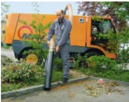
Grosse (Saug)Wirkung: Handsaugschlauch für dichtes Laub oder Gullyschächte.
