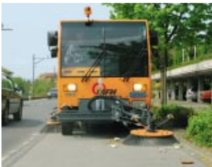
Breites Arbeitsspektrum: Der Frontbesen ist beidseitig ausfahrbar und kehrt so von 90 cm schmal bis 290 cm breit.
