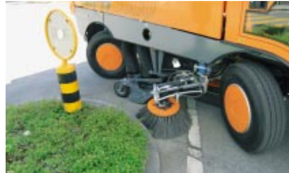
Eng um die Kurven: Dank Vier- radlenkung kleinster Kehrradius von 67 cm.
