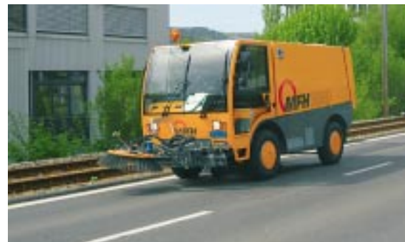
Schnell an Ort und Stelle: Aebi MFH 5000 fährt auf Haupt- strassen bis 62 km/h schnell.
