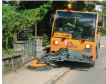
Auf schmalen Gehsteigen kann versetzt gefahren und gearbeitet werden.
