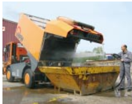
Aebi MFH 5000 reinigt mit Hochdruck Behälter, Fassaden, Schilder usw.
