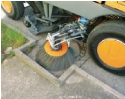
Optimale Nischenreinigung: Der Seitenbesen ist ausfahrbar und hydraulisch verstellbar.
