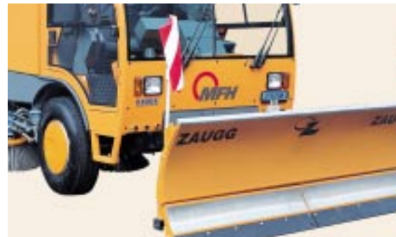
Dreifaches Plus für den Winter- dienst: Schneeflug, Kehr- maschine und Vierradantrieb.
