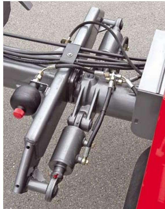
**Un élément de sécurité important: l'amortisseur de torsions hydrauliques disponible en option, sans à-coups brusques. Avec un angle de torsion maximal de 24° par côté, les roues restent toujours bien ancrées au sol.**
