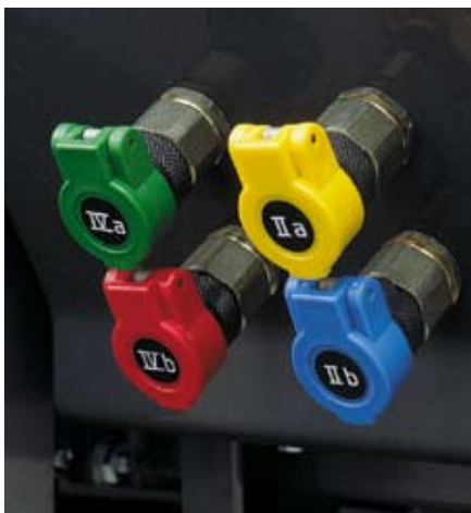
Divers raccords hydrauliques clairement signalés élargissent, selon nécessité, le spectre d'utilisation du TP68.
