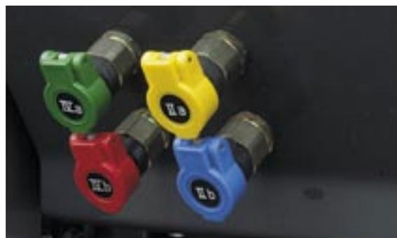
**Divers raccords hydrauliques clairement signalés élargissent le spectre d'utilisation du TP88.**
