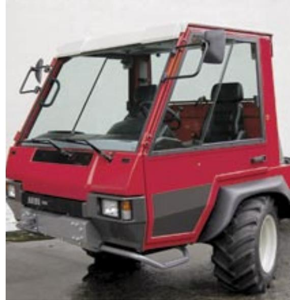
**En option: cabine fermée à suspension pneumatique, pourvue d'un chauffage performant.**
