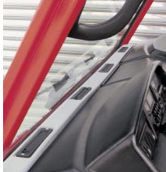
**Les ouvertures de ventilation pour les pare-brises de l'installation de dégivrage et de chauffage disponible en option. Non visibles: les ouvertures de ventilation vers l'espace des pieds.**
