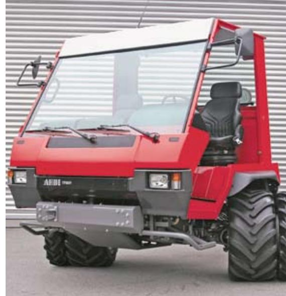
**En option: cabine à suspension pneumatique. Suspension de la cabine sur amortisseurs et amortissement hydraulique offrant un confort de conduite optimal. En l'occurrence, indépendamment de la charge transportée et ce également en pentes raides, car les stabilisateurs veillent automatiquement à ce que la cabine ne puisse s'incliner en aval.**
