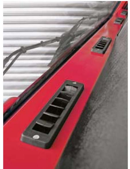
**Les ouvertures de ventilation pour le pare-brise de la climatisation disponible en option, resp. du dégivrage et du chauffage extrêmement performants. Non visibles: les ouvertures de ventilation aérant l'espace des pieds.**
