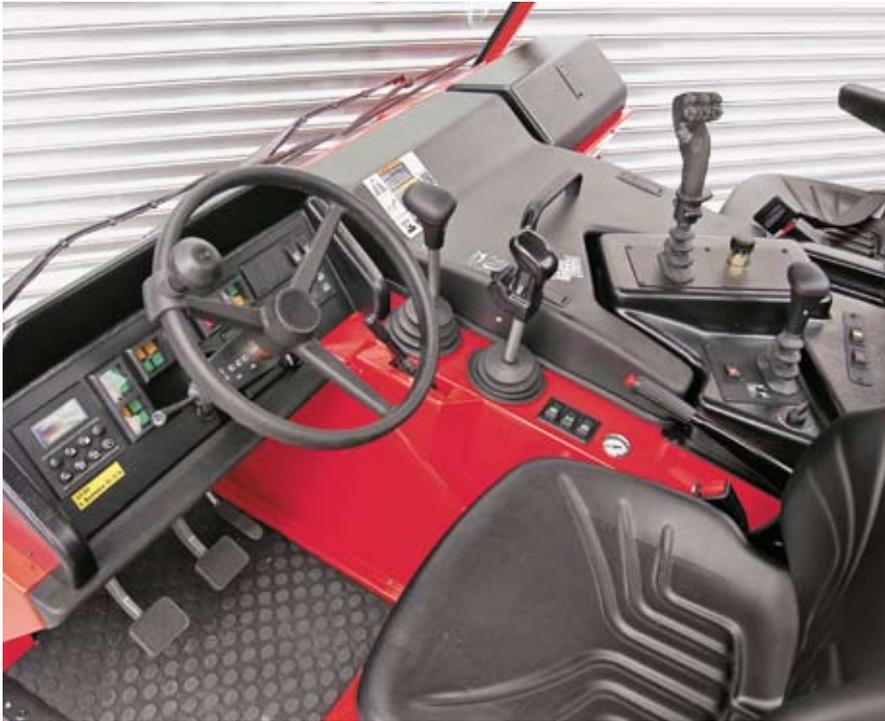
**La vaste cabine aménagée de manière agréable et pratique est extrêmement conviviale et offre au conducteur une vue panoramique parfaite, grâce au pare-brise et à la vitre arrière généreusement dimensionnés. Au centre de l'image, on voit le levier de changement de vitesse pour la boîte à inversion d'un fonctionnement aisé, grâce aux demi-vitesses subtilement étagées avec respectivement 16 rapports avant et 16 rapports arrière.**
