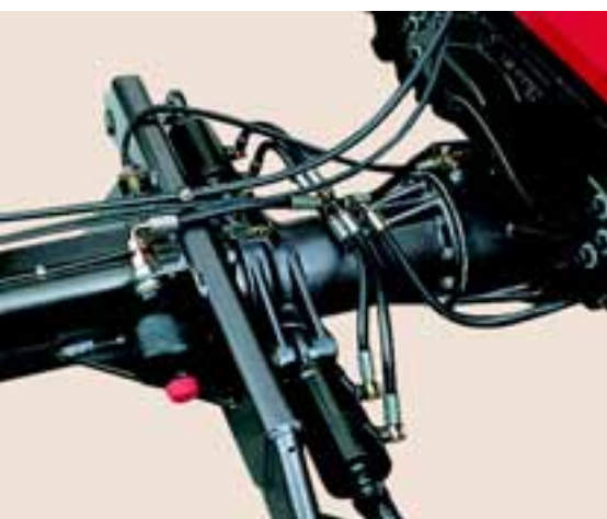
Amortissement de torsion hydraulique à effet progressif entre l'essieu avant et arrière.
