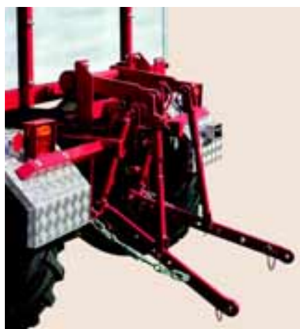
Pour des possibilités de montage supplémentaires: le vérin hydraulique 3 points arrière selon cat. I + II.
