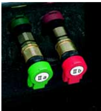
Raccords hydrauliques clairement signalés. Ne gouttent pas.
