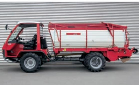
**L'autochargeuse Aebi LD31K pour Transporter avec empattement 2,75 m. Avec la hausse à fourrage rabattue, la hauteur totale reste compacte et permet d'éviter toute surcharge lors du chargement de fourrage lourd.**
