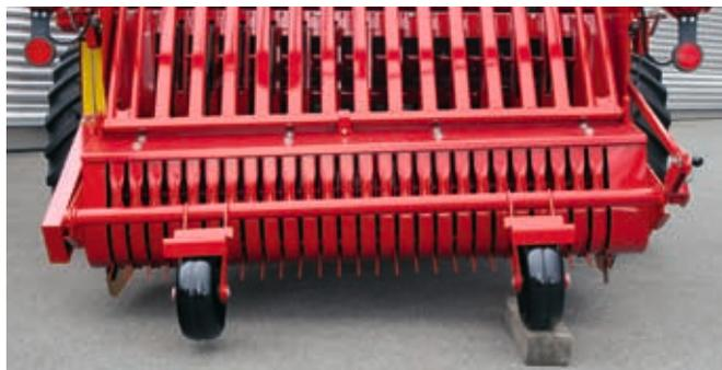
L'adaptation parfaite au sol avec la commande *Contour* – se compose de l'adaptation automatique de la hauteur des dents du pick-up commandée par les roues-supports – et le pick-up oscillant.
