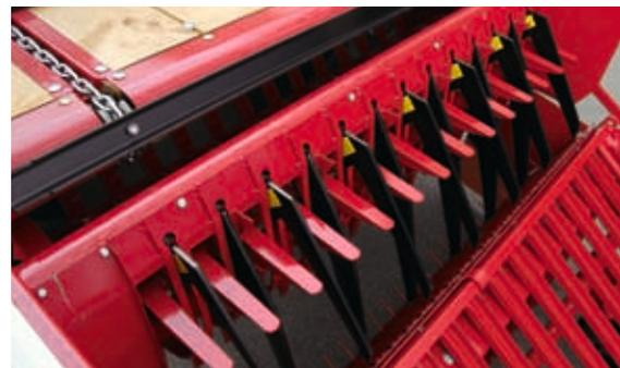
Le large et vaste canal d'amenée avec les trois traverses d'amenée et les 13 couteaux au maximum sur deux niveaux de coupe.
