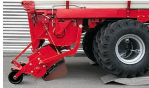
Pick-up dans sa position abaissée maximale. Rail de réglage pour la commande *Contour* et le relevage des roues-supports pour le chargement stationnaire permettant de charger confortablement et sans entrave.
