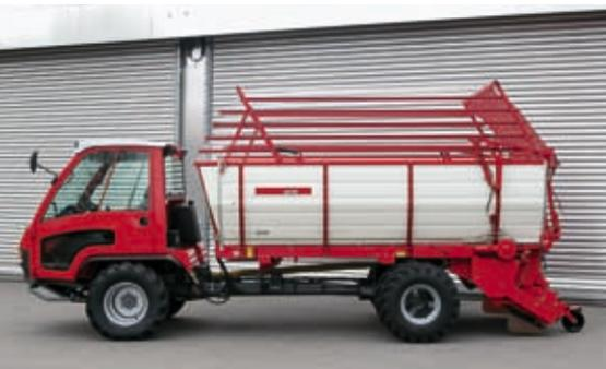
**L'autochargeuse Aebi LD31L pour Transporter avec empattement 3,15 m. Avec la hausse à fourrage relevée, la capacité de chargement est de 19 m<sup>3</sup> avec un pressage moyen.**
