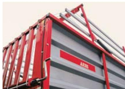
**Manivelle aisée pour le réglage progressif de la hausse à fourrage.**
