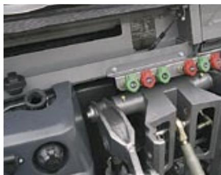
**Les dispositifs de levage avant et arrière peuvent chacun être équipés de deux raccords hydrauliques à double effet et d'une soupape moteur.**
