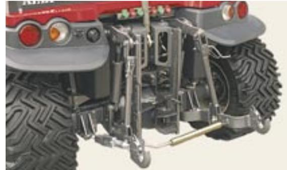
Les dispositifs de relevage avant et arrière peuvent également être commandés de l'extérieur. De plus, un accouplement de remorquage à réglage rapide est installé à l'arrière.
