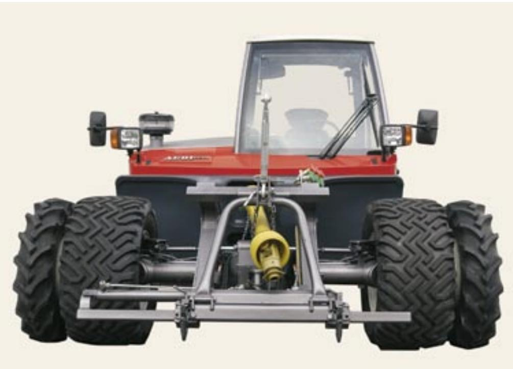
**L'électronique moderne du TT170 mesure automatiquement la pression hydraulique en relevant l'accessoire. Le conducteur peut ensuite introduire le degré de décharge souhaité en pour cent, et le système hydraulique règle de lui-même la pression de décharge nécessaire. De ce fait, le conducteur peut se concentrer entièrement sur son travail.**
