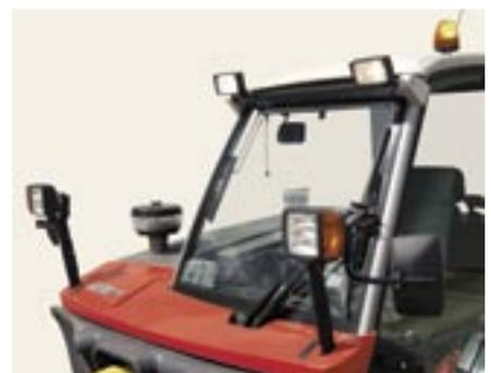
**Les phares du véhicule sont relevables en cas de besoin (p.ex. pour le service hivernal) et peuvent être complétés en option d'une paire de phares de travail montés à l'avant du toit.**
