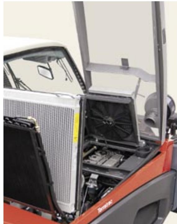
Le système de refroidissement du moteur diesel et de l'huile hydraulique est spécialement adapté pour des conditions de travail poussiéreuses. Pour procéder au travaux de nettoyage, il suffit de le rabattre.
