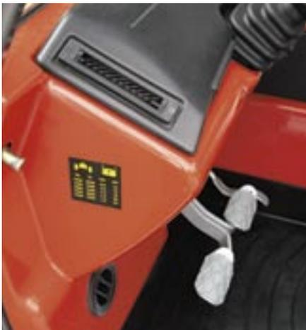
**Les ouvertures de ventilation du chauffage et de la climatisation disponible en option.**
