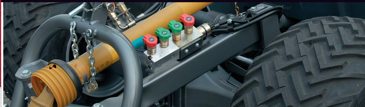
Raccords hydrauliques au dispositif de levage avant
