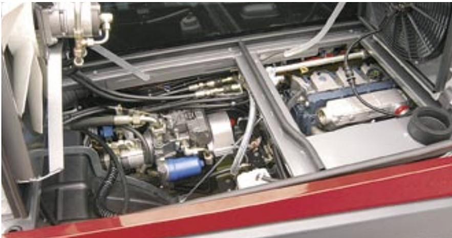
**Grâce à l'injection directe, le moteur turbo VM 95 CV de Detroit Diesel développe une grande force de traction, avec une consommation tout de même économique. Il est aisément accessible et d'un entretien facile par simple rabattage des systèmes de refroidissement.**
