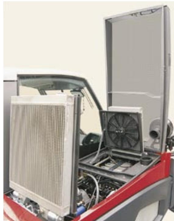
**Le système de refroidissement du moteur diesel et de l'huile hydraulique est spécialement adapté pour des conditions de travail poussiéreuses. Pour procéder aux travaux de nettoyage, il suffit de le rabattre.**
