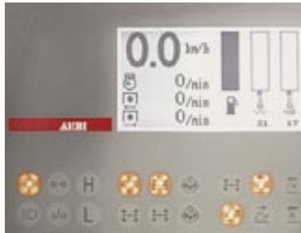
**Le menu électronique, visualisé sur l'écran (dans l'une des 4 langues possibles), se sélectionne sur le clavier à droite du levier de marche. Les valeurs critiques relatives à l'état de fonctionnement y sont immédiatement signalées de manière explicite.**
