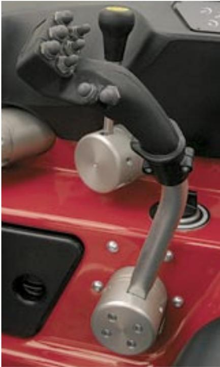
**Vingt fonctions au total peuvent être sélectionnées au levier multifonctions, sans devoir changer de main.**
