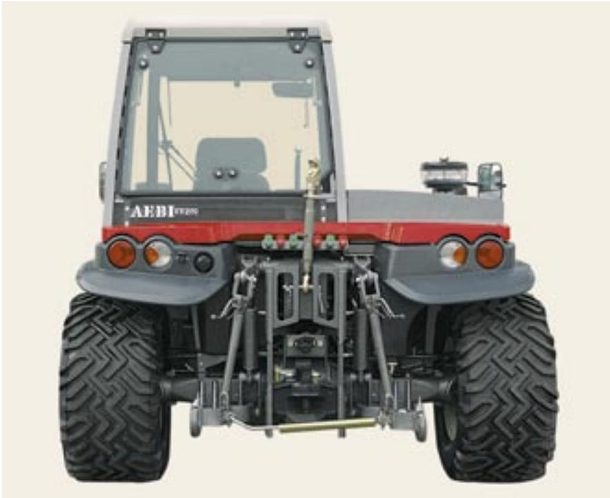
**Les essieux du nouveau TT270 sont conçus pour faire face à des contraintes extrêmement hautes et le vérin de braquage est doté d'une protection spéciale. Typiques pour un Terratrac: la construction de petite hauteur et le centre de gravité placé bas.**
