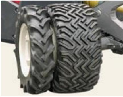
**Le TT270 est équipé des nouveaux pneus radiaux «All Ground». Ils peuvent être complétés à l'avant et à l'arrière par des roues jumelées. Avec un angle de braquage de 40 degrés à l'avant et à l'arrière (30 degrés avec les roues jumelées), ce Terratrac affiche une maniabilité extrême en toute situation.**
