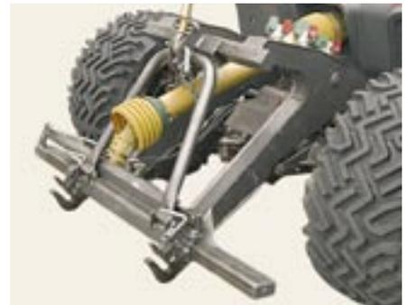
**Deux régimes de prise de force sont disponibles à l'avant et à l'arrière. L'enclenchement se fait électrohydrauliquement sous charge. Les dispositifs de relevage peuvent également être actionnés de l'extérieur.**
