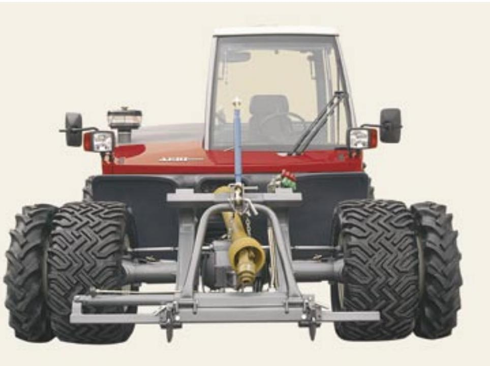
**L'électronique du TT270 établit automatiquement la pression hydraulique nécessaire pour le relevage des accessoires. Le conducteur peut indiquer le degré de décharge souhaité en pourcent, et le système hydraulique règle la pression nécessaire. Cette simplification permet au conducteur de se concentrer davantage sur le travail proprement dit.**
