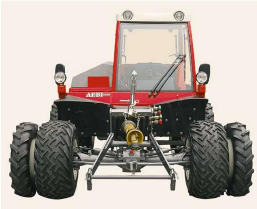
**Des roues jumelées peuvent également être montées à l'avant du TT55, en complément à l'arrière, sans pour autant réduire l'angle de braquage...**
