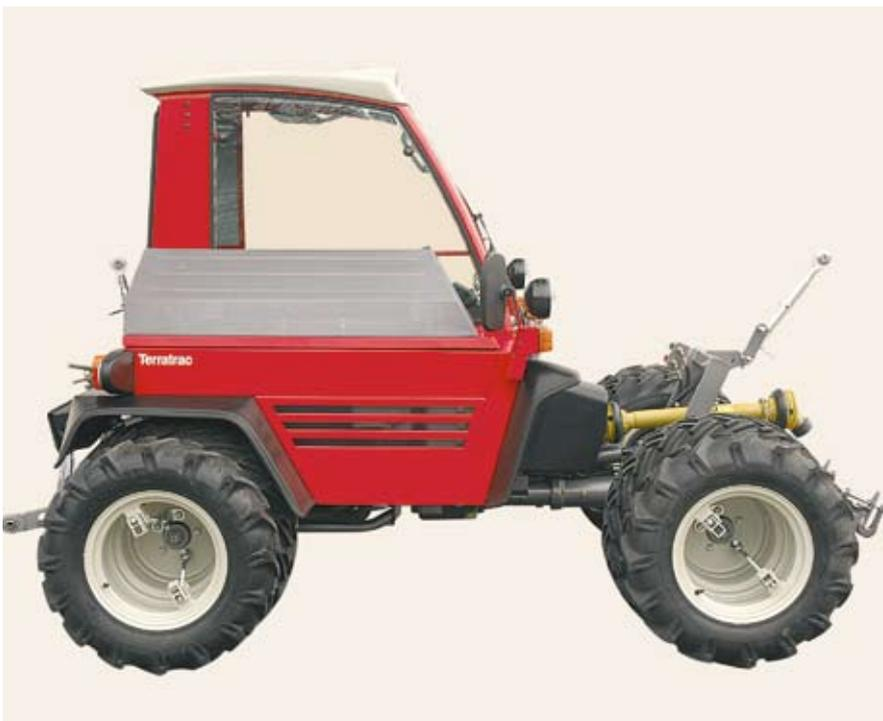
**... Cela a été possible en rallongeant l'empattement. De plus, celui-ci a un effet extrêmement positif sur les caractéristiques de conduite et sur la répartition du poids lorsqu'un accessoire est accouplé au véhicule.**
