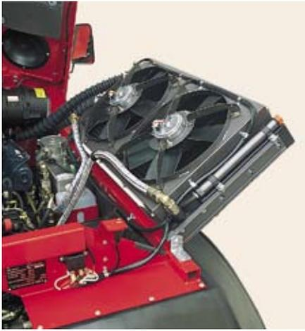
**Le radiateur est facilement escamotable – et le compartiment moteur est librement accessible.**
