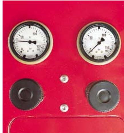
**Réglable progressivement à l'avant comme à l'arrière: la décharge hydraulique des accessoires.**
