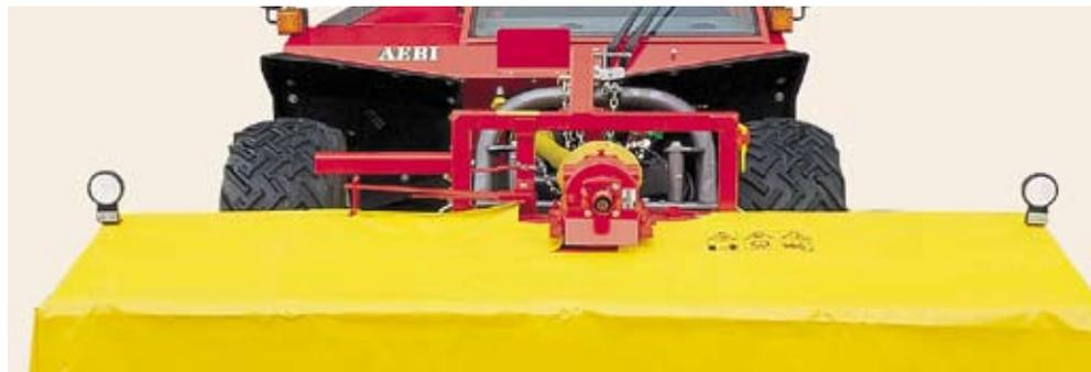
**Le cadre de levage avant peut être déplacé jusqu'à 31,5 cm vers la gauche ou vers la droite. Ceci permet de travailler avec davantage de précision, simplifie le montage des accessoires et constitue un avantage indéniable en pentes raides.**
