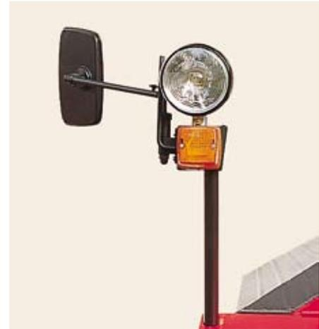
**En un tour de main, les phares du Terratrac peuvent se régler à volonté en hauteur, ou même se démonter en cas de nécessité.**
