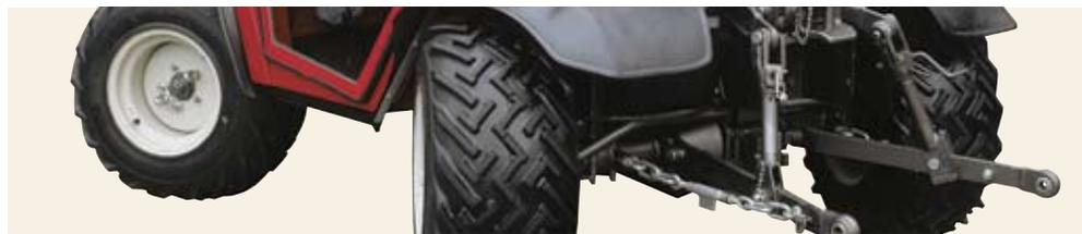
**Un coup d'œil sur le système de direction: il suffit d'appuyer sur un bouton et le mode de direction le mieux approprié et préservant le mieux le sol est déjà présélectionné: direction avant pour les interventions usuelles, direction arrière pour une meilleure précision, direction intégrale et marche en crabe pour davantage de flexibilité. (L'angle de braquage se réduit à 2,9 m.)**
