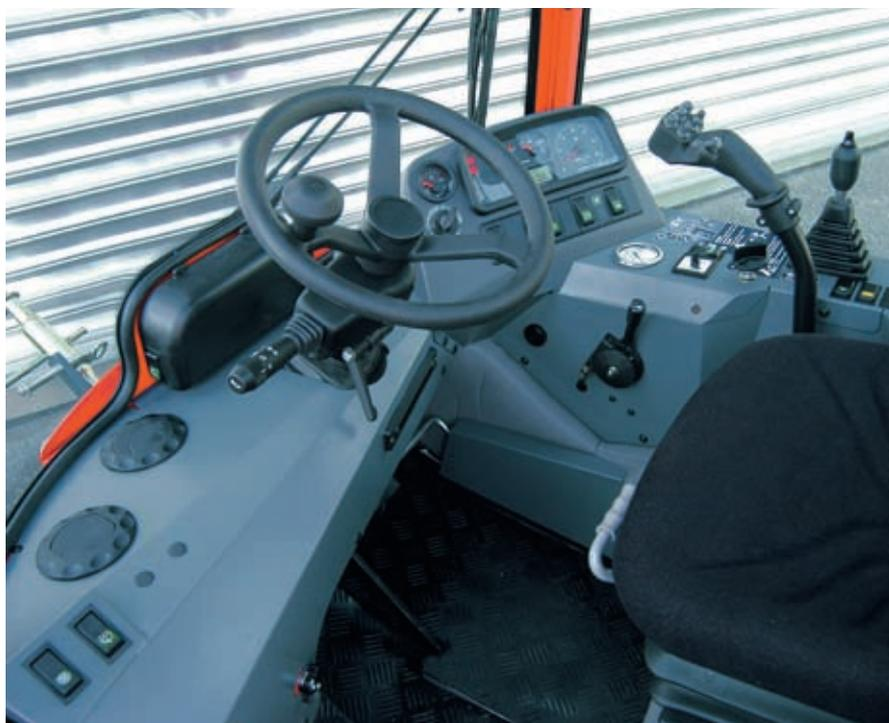
**Visibilité au profit de la sécurité:** la visibilité bien pensée, l'excellente insonorisation, le siège réglable à suspension pneumatique, la climatisation et bien d'autres agréments encore font de la cabine une place de travail de grand confort. Et la commande avec le levier multifonctions agencé avec ergonomie permet de rouler progressivement d'une main en marche avant ou arrière, tout en activant simultanément par électrohydraulique toutes les fonctions hydrauliques.
