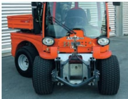
**L'astuce avec l'articulation:** l'éprouvée direction articulée stable offre un rayon de braquage exceptionnel de 0,9 m à l'intérieur et de 2,3 m à l'extérieur.
