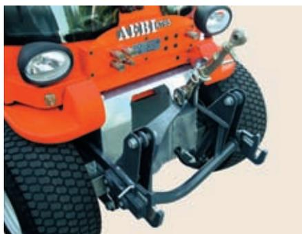
**Génial, à l'avant comme à l'arrière:** l'hydraulique avant et arrière à double effet avec position flottante fait du KT65 Aebi une machine réellement multifonctionnelle. La décharge hydraulique des accessoires à l'avant ainsi que le système de fixation rapide KT pour les accessoires en font également partie.
