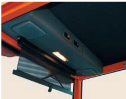
**La cabine, offrant une visibilité parfaite, n'est pas seulement climatisée mais également insonorisée. De plus, elle est basculante comme le plateau de chargement, afin que tous les points nécessaires soient librement accessibles pour les travaux d'entretien.**
