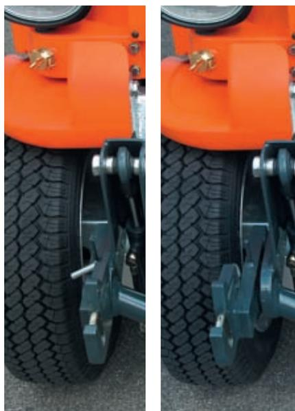
**Montage flexible des accessoires:** le dispositif de levage avant 3 points (cat. I) est adaptable en un tour de main aux accessoires Rasant déjà existants.
