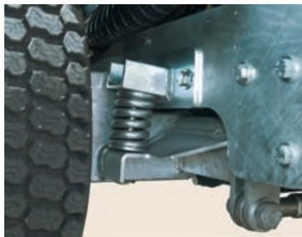
**A l'aise aussi en biais:** grâce à son articulation à charnière intelligemment conçue, le Aebi KT65 suit fidèlement sa trace, même avec un braquage intégral. Ceci est dû à l'exceptionnelle direction articulée, à la suspension à roues indépendantes avec stabilisateur et au centre de gravité placé bas du fait des quatre moteurs à moyeu de roue.
