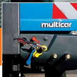
**Raccordements du système hydraulique à l'avant, à l'arrière et latéraux**
