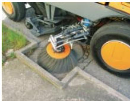
**Nettoyage optimal des renforcements:** le balai latéral extensible est réglable par un système hydraulique.
