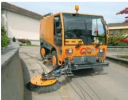
**Balai frontal sur le trottoir et balayage simultané de la rue:** toutes n'en sont pas capables...
