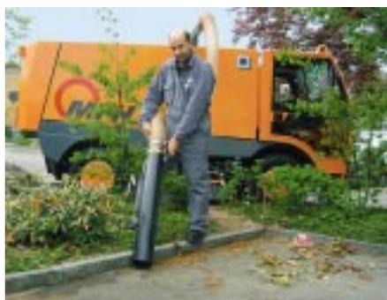
**Effet (d'aspiration) puissant:** tuyau manuel pour les amas de feuilles mortes et les bouches d'égout.
