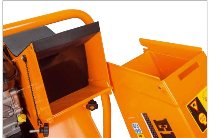
An der Maschinenfront befindet sich ein Sicherheitsschalter, damit die Maschine nur bei richtig eingesetztem Fangkorb arbeitet; ein Magnet verhindert ungewolltes Herausrutschen des Korbs
