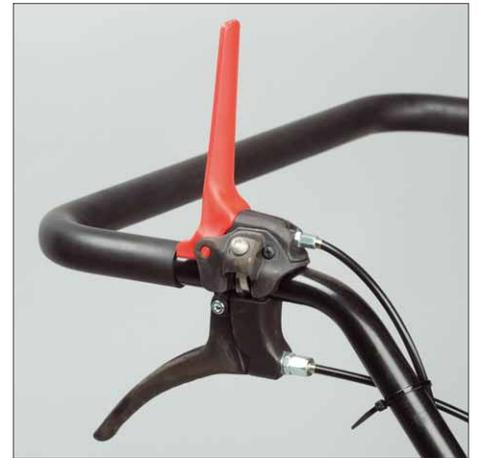
Der rote Hebel schaltet die Messerwelle ein, der schwarze Hebel den Antrieb
