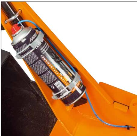
Eine Kette sorgt für den Kraftfluss auf die Antriebswalze. Damit der Kettentrieb nicht jedes Mal zum Schmieren zerlegt werden muss, hat Eliet die Schmiervorrichtung gleich integriert
