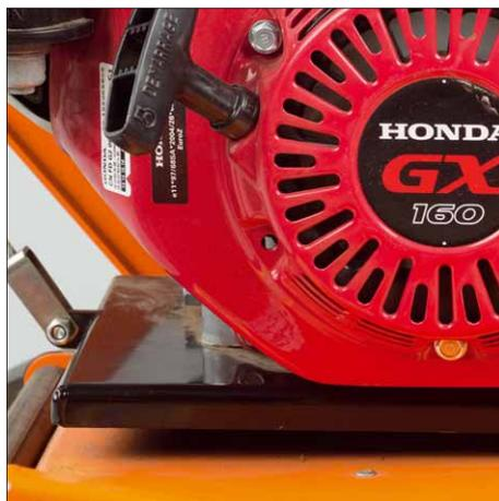
Liegt die Motorlagerplatte hinten auf, ist der Keilriemen lose und die Messerwelle steht still. Ziehen des Bedienhebels am Griffholm hebt die Motorplatte hinten an, der Keilriemen spannt sich und die Messerwelle arbeitet
