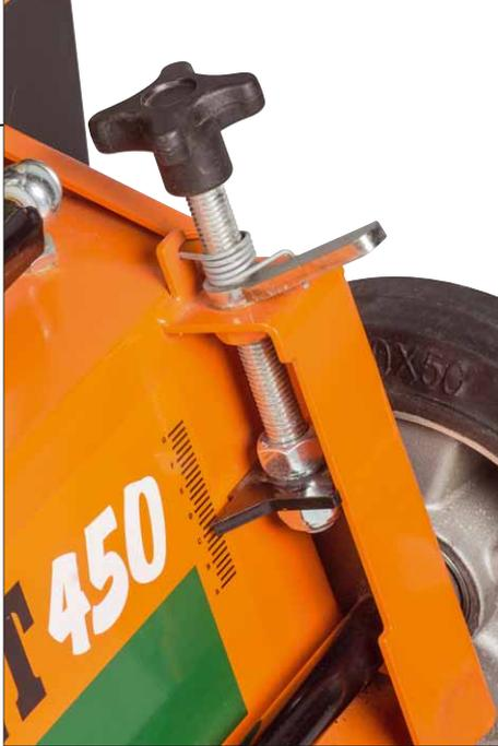
Die Arbeitshöhe wird per Stellschraube an jedem der beiden Vorderräder einzeln eingestellt
