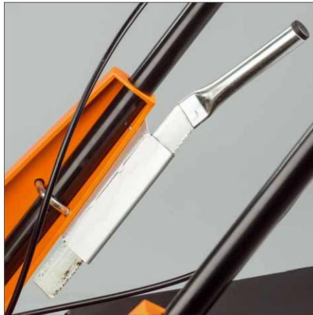
Um eine eventuell verkrautete Messerwelle zu reinigen, wird gleich eine Reinigungssäge mitgeliefert
