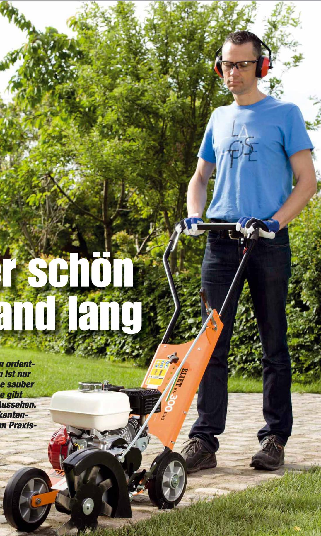
**D**ie Pflege der Rasenkante ist mitunter der aufwendigste Teil der Rasenpflege. Gerade in großen Park- und Grünanlagen sind sie oft Hunderte Meter lang. Eine solche Aufgabe ist von Hand kaum zu lösen, deshalb wurden Kantenschneider entwickelt. Mit ihnen wird die Rasenkante in einem Bruchteil der Zeit geschnitten, die ein Mensch mit der Hand benötigen würde.
