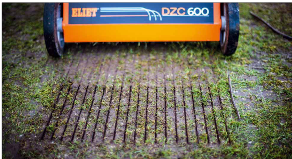
Die Frästiefe sollte zuerst ausprobiert werden, um die optimale Arbeitstiefe der Messer zu bestimmen
