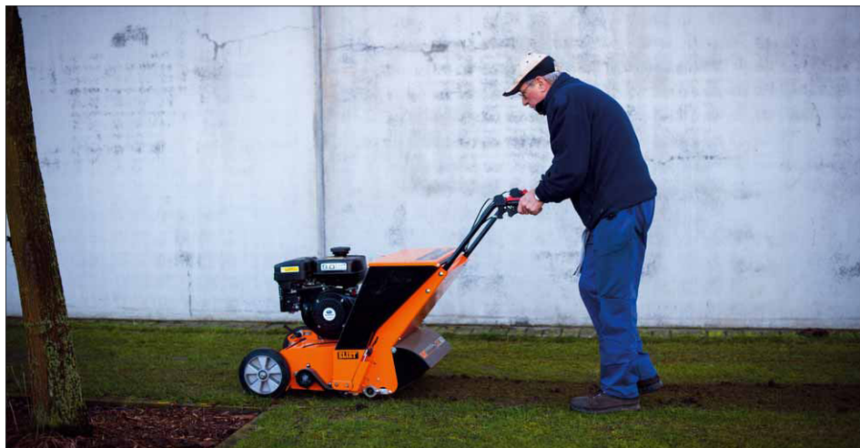
Bei der Arbeit nimmt die Maschine Boden auf und streut ihn nach hinten über dem Saatgut wieder aus
