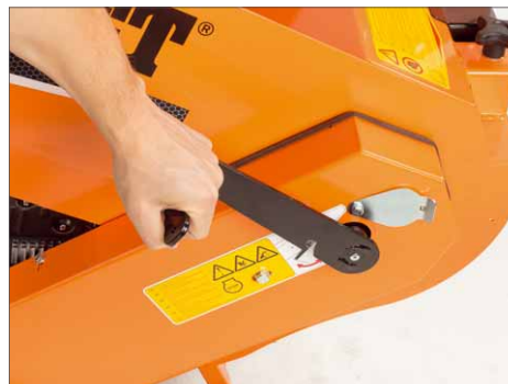
Hat sich die Messerwalze wirklich mal verklemmt, kann sie per Handkurbel zurückgedreht werden
