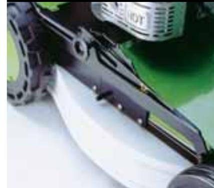
HALBZENTRALE STUFENLOSE HÖHENEINSTELLUNG
