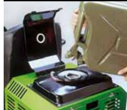
BENZINTANK MIT SICHERHEITSSCHLUSSEL UND ÜBERLAUFSTUTZEN
