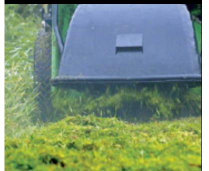
MÄHEN IM HOHEN GRAS MIT HYDRAULISCH GESTEUERTEM DEFLEKTOR
