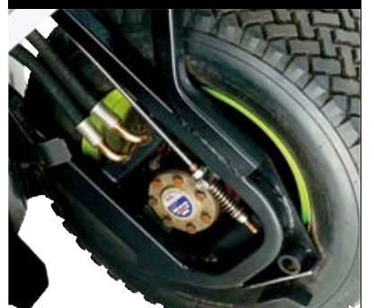
KEINE HINTERACHSE, ANTRIEB DURCH RADMOTOREN
