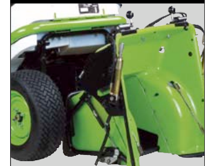
SCHNELLES ABMONTIEREN DES FANGKORBES H100D
