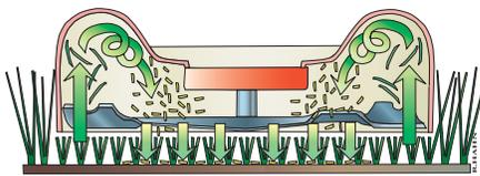
Dank des Mähwerkes in Glockenform und der innovativen biocut-Messerform des ETESIA-Mulchers wird das Gras aufgerichtet, geschnitten, fein zerkleinert und gegen den Boden gepreßt. Das Mulchen verlangt häufigeres Mähen, sonst neigt der Rasen zum Verfilzen.
