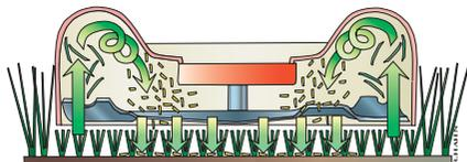
Glockenform und der innovativen biocut-Messerform wird das Gras aufgerichtet, geschnitten, fein zerkleinert und dann gegen den Boden gepresst. Somit erhalten Sie einen sauberen, schnellen und ökologischen Schnitt.
