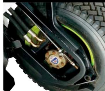
PAS D'ESSIEU ARRIERE, TRANSMISSION PAR MOTEURS DE ROUES
