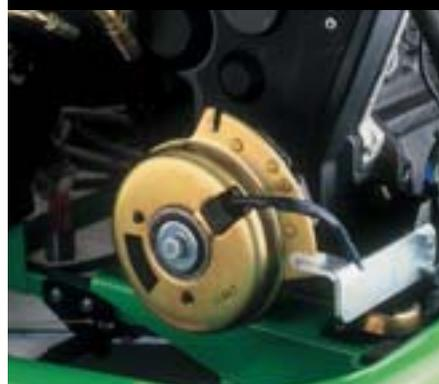
EMBRAYAGE ELECTROMAGNETIQUE DES LAMES
