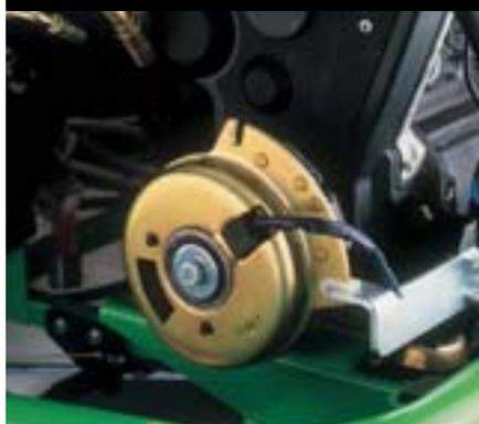
EMBRAYAGE ELECTROMAGNETIQUE DES LAMES
