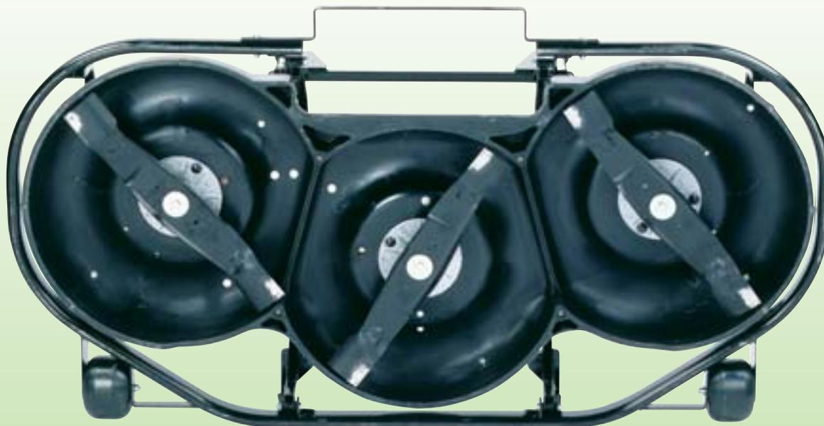
Le plateau de coupe biocut 144 est un système de coupe mulching d'une largeur de coupe de 1,44 m. Il est composé de trois unités de coupe biocut, se chevauchant et positionnées en arc. Chaque unité de coupe se caractérise par le profil en cloche du carter et la
