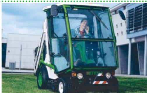
**Balayeuse frontale MT 124 :** Bac pour balayeuse : bac MU 124 pour balayeuse MT 124. Vidange hydraulique. Largeur de travail 1,35 m, orientable droite / gauche.
