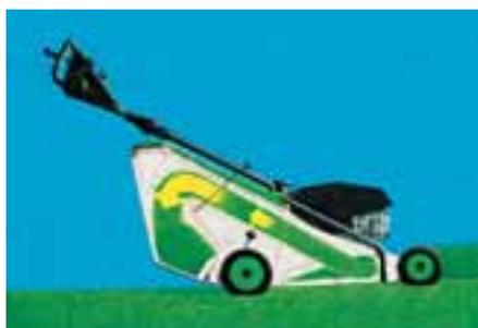
Les tondeuses avec ramassage d'ETESIA sont toutes construites autour d'un ensemble carter avec bac intégré et lame profilée, destiné à redresser l'herbe, la couper, puis la projeter directement dans le bac de ramassage par un effet d'aspiration et de soufflerie. L'aérodynamisme intérieur du carter et le large canal d'éjection suppriment tout risque de bourrage.
