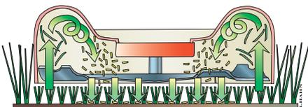
Grâce au carter en cloche et à la lame biocut de la mulcheuse ETESIA, l'herbe est redressée avant la coupe, puis maintenue sous le carter pour être coupée et recoupée avant d'être projetée en fines particules qui se décomposent naturellement.
