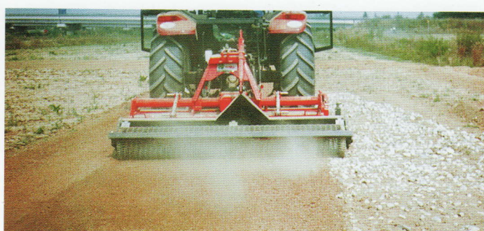
Interramento pietre per preparazione letto di semina. Stone burying for seed-bed preparation. Enfouissement des pierres pour la préparation du lit de semailles. Eingraben von Steinen zur Vorbereitung des Saatbettes.
