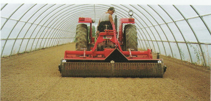
Interramento sassi e detriti e semina in un unico passaggio. One-pass stone and debris burying and sowing. Enfouissement des cailloux et des débris et semailles en un seul coup. Eingraben von Steinen und Rückständen und Säen in einem Arbeitsgang.
