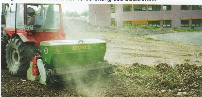
Interramento sassi e detriti e semina in un unico passaggio. One-pass stone and debris burying and sowing. Enfouissement des cailloux et des débris et semailles en un seul coup. Eingraben von Steinen und Rückständen und Säen in einem Arbeitsgang.
