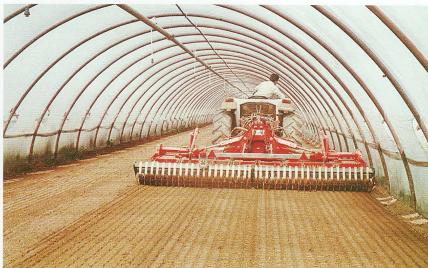
Preparazione del letto di semina per ortaggi in serra da metri 7,5. Seed-bed preparation for vegetables in green-houses 7.5 m width. Préparation du lit de semilles pour produits potagers de serre de 7,5 mètres. Saatbeet-Vorbereitung für Gemüse im Gewächshaus bis zu 7,5 m Arbeitsbreite.
