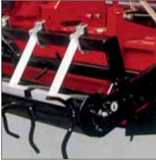
Rullo a spuntoni. Spike roller. Rouleau à pointes. Zinkenwalze.
