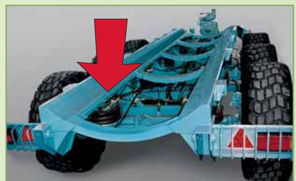
Telaio e sospensioni ad aria autolivellanti (Torpress).
