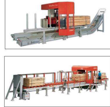
Modelul nostru Vario Cut a fost conceput special pentru solicitarile unde inalta performanta este o necesitate. Aceasta masina se distinge printr-un batiu deosebit de robust, un ghidaj vertical al sinei foarte stabil, disponand in acelasi timp si de posibilitatea de control al acestiei in timpul taieriei.
